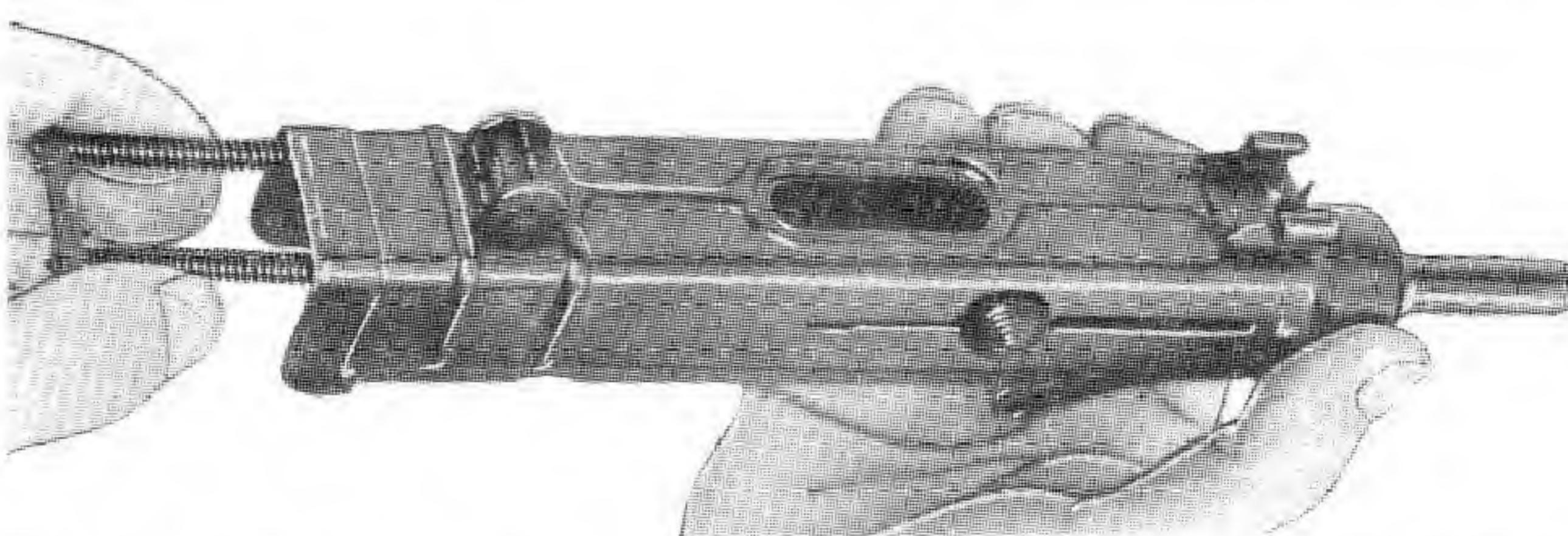
Sl. 57 – Dovođenje zatvarača sa opružnim povratnikom u stanje mogućeg odvajanja hvatača zatvarača
